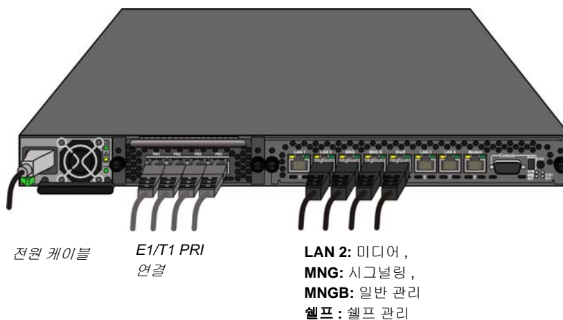
그림 1-1 AC 전원 및 통신 케이블을 포함한 RMX 1500 뒷면 패널 보기
